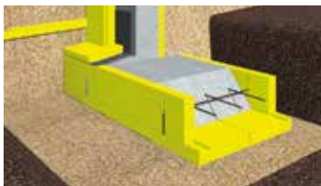
Finnfoam Anturamuotti on kustannustehokkain ja turvallisin tapa toteuttaa anturat.
