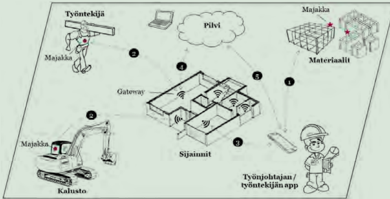
Kuva 2: iCONS-järjestelmän tavoite. Kussakin sijainnissa on vastaanotin (ns. gateway). Seurattavilla henkilöillä, materiaalilla ja kalustolla on ns. majakka. Työntekijä tai työnjohtaja saa mobiililaitteeseensa sijaintipohjaista tietoa.
